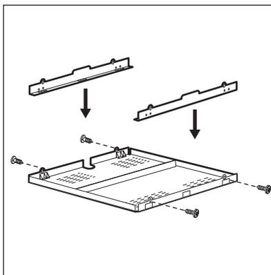
Po zamontowaniu kasety ochronnej (wyposażenie dodatkowe) nie ma konieczności montażu przegrody zabezpieczającej bezpośrednio pod płytą grzejną. Akcesoria ochronne mogą być niedostępne w niektórych krajach. Skontaktować się z serwisem.
